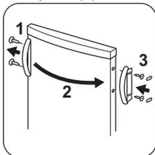
12. Reintroduceți știfturile capacelor (3) pe partea opusă.
